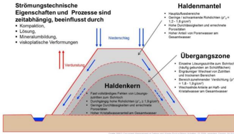
Abbildung 6: Hydraulische Modellvorstellung zum internen Haldenaufbau (aus Band 3.15, S. 95).
